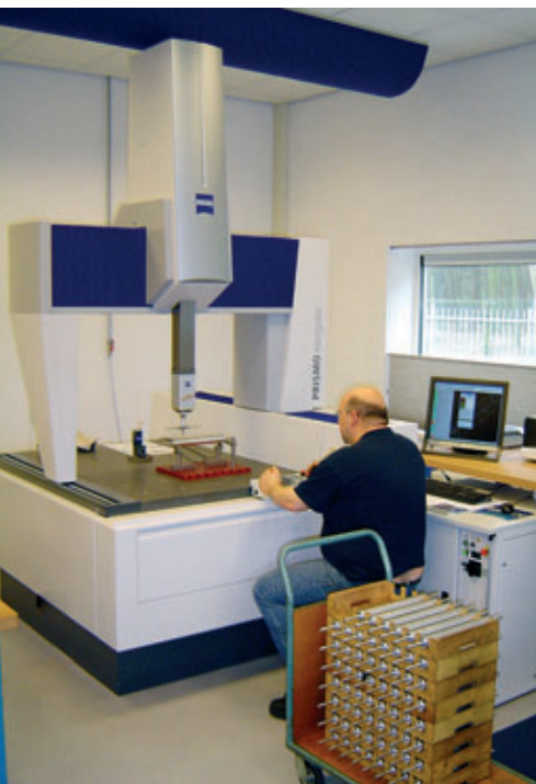
Klimatisierter Meßraum mit neuer 3D-Meßmaschine von Zeiss. Vorne: Wellen für Kopierautomaten, wozu Komponenten auf star*-CNC-Langdrehautomaten produziert werden.
